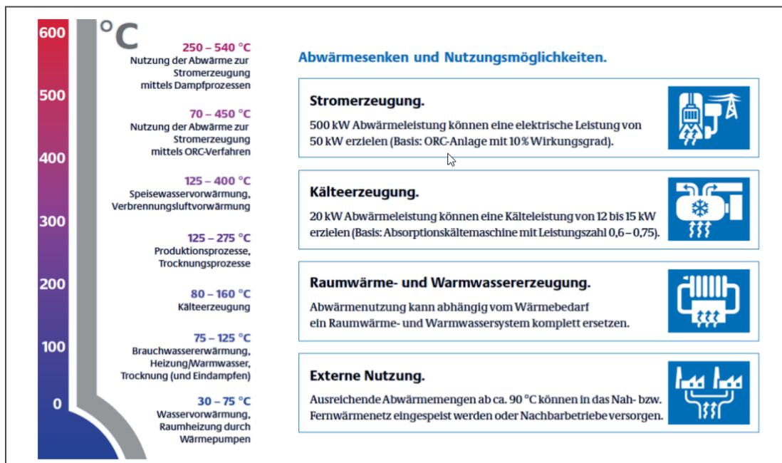
Abbildung 4-7: Nutzung von industrieller und gewerblicher Abwärme in Abhängigkeit vom Temperaturniveau [dena]
